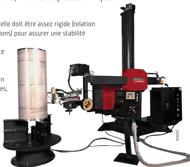
Plateaux tournants standards de 5 à 30 T Jusqu'à 4 500 mm de diamètre
