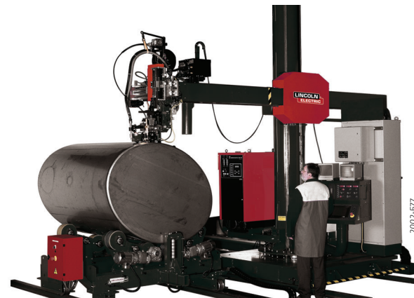
Soudage elliptique avec potence sur vireur
