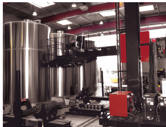
Plateaux tournants standards de 5 à 30 T Jusqu'à 4 500 mm de diamètre
