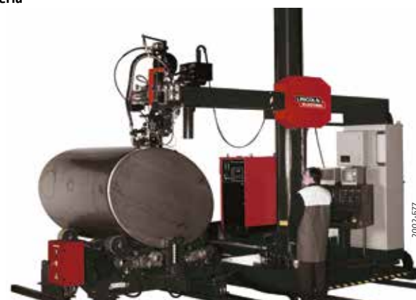
Soldadura elíptica con columna y brazo en virador
