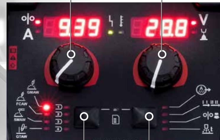
Ajuste de la velocidad de alimentación del hilo (m/min)
