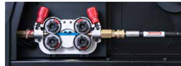
Разъем для подачи от барабана (переходник, опция). Более длительная работа на одном барабане, экономит время
