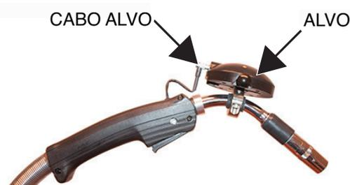
15. Conecte o cabo alvo no conector da pistola apropriado no CPU. Consulte a figura A.20.
