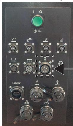
**CONEXÃO PENDENTE DE AJUSTE DA ALTURA**
