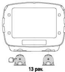
13 pav. Patikrinkite, ar baterijos teigiama (+) polius yra nukreiptas į viršų
