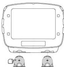
Imagem 13 Certifique-se de que o lado positivo (+) da bateria fica virado para cima
