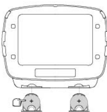
kuva 13 Varmista, että akkujen positiivinen (+) puoli osoittaa ylöspäin.
