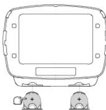
fig. 13 Vær sikker på, at batteriets Positive (+) side vender opad
