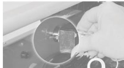
17. Réinstallez l'écrou de montage sur l'interrupteur. Serrez à la clé.
