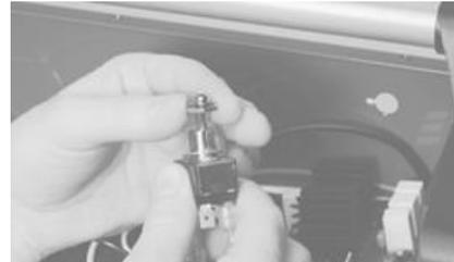
16. Installez l'interrupteur dans le trou du panneau. Assurez-vous que la languette de la rondelle est bien insérée dans le plus petit trou.
