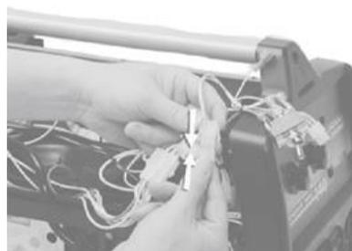
10c. Branchez le faisceau de l'adaptateur P8 (6 broches) au faisceau de la minuterie de repérage J9 (6 broches).
