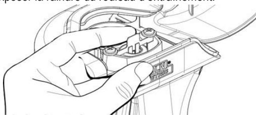
8. Guidez le fil redressé à travers le guide d'entrée et vers la rainure du rouleau d'entraînement.
