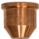
**A tubeira** é o consumível que se substitui com mais frequência. Um dos sinais que indica que a tubeira deve ser substituída é a acumulação excessiva de escórias e o ângulo do biselado presentes nos cortes. Na própria tubeira, se o orifício se alonga ou se torna irregular são sinais de desgaste excessivo.
