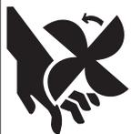
1.f. No poner las manos cerca del ventilador del motor. No tratar de sobrecontrolar el regulador de velocidad en vacío empujando las varillas de control del acelerador mientras el motor está funcionando.
