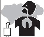
1.b. Ne faire fonctionner les moteurs qu'à l'extérieur ou dans des endroits bien aérés ou encore évacuer les gaz d'échappement du moteur à l'extérieur.
