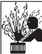
1.h. Pour éviter de s'ébouillanter, ne pas enlever le bouchon sous pression du radiateur quand le moteur est chaud.
