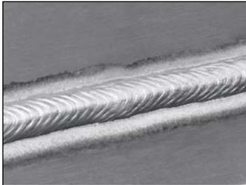
Pulse-On-Pulse en lámina de aluminio de 3 mm
