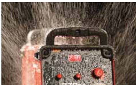
Test IP en el laboratorio de Lincoln
