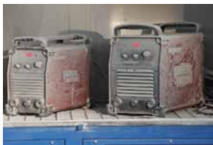
Ensayo de suciedad
