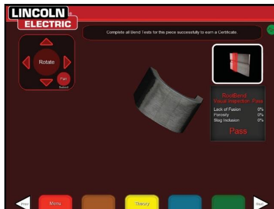
Rysunek 100 – ukończona próba zginania
