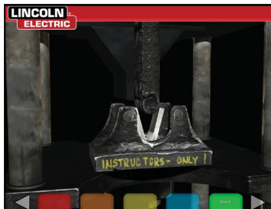
Rysunek 102 – ukończona próba zginania
