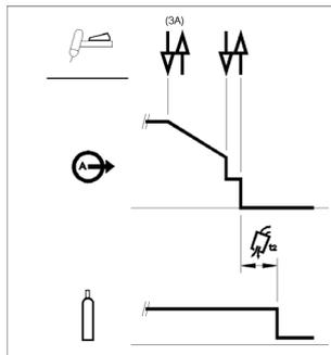
Esta secuencia de funcionamiento de 4T con reinicio desactivado es el ajuste predefinido en fábrica.
