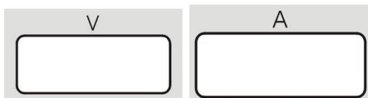
El medidor derecho muestra la corriente de soldadura predefinida (A) antes de soldar y la corriente real de soldadura durante el trabajo. El medidor izquierdo muestra la tensión (V) en los cables de la salida.
