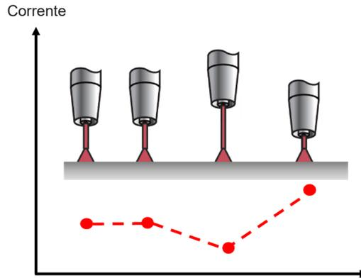
Além disso, o «TAST» utiliza a função de varrimento do robot para determinar a posição lateral da tocha na junta de soldadura.
