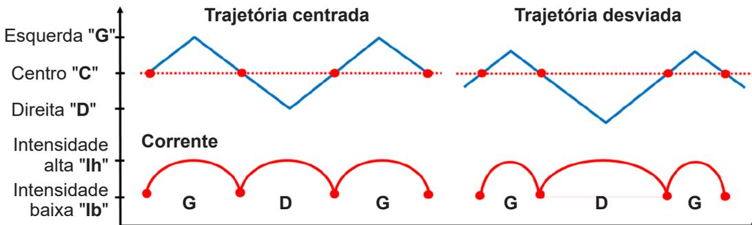
O «TAST» permite corrigir as juntas de solda imperfeitas, mas exige configuração minuciosa das variáveis do sistema e necessita um conhecimento aprofundado do processo de soldar.
