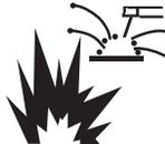
Las **CHISPAS DE SOLDADURA** pueden provocar un incendio o explosión.
