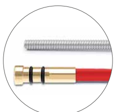
Spezielle Drahtförderschläuche aus höherfesten Materialien: steifere Schläuche, weniger Reibung, längere Standzeit
