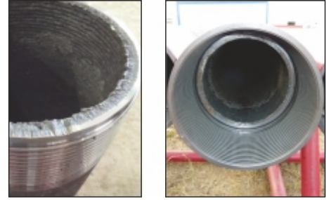
Diş Açılmış Erkek ve Dişi Bağlantı Uçları — Kaplin ile Birleştirme —
