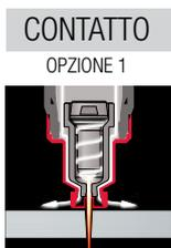
Comodo per l'operatore, basta trascinare l'ugello sulla lamiera. Ugello ben protetto.
