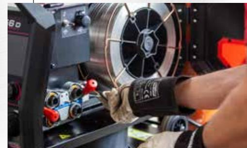
**Gute Zugänglichkeit beim Einsetzen von Drahtspulen**
