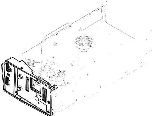
4. Utiliser un tournevis à douille de 5/16" pour retirer les vis qui maintiennent le couvercle de refroidissement d'eau sur le devant du module interne et sur l'arrière de la console.
