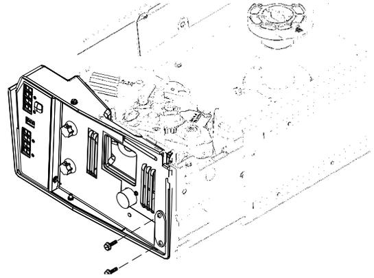
5. Installer l'ensemble accessoire et tuyau sur le devant de la console. Acheminer les tuyaux le long du bas du module interne puis les faire sortir par la découpe du couvercle. Faire glisser le module pour le remettre dans la console.
