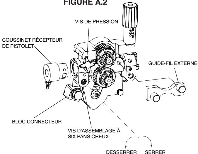
8. Brancher le tuyau à gaz de protection sur le nouveau coussinet de pistolet, si besoin est.
