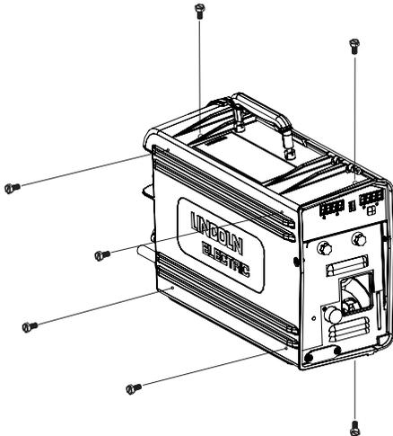
3. Retirer le module de la console en soulevant l'avant du module d'environ 0,25" (6 mm) puis en le faisant glisser vers l'avant.
