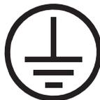
Le châssis de la soudeuse doit être raccordé à terre. Une terminale de terre portant le symbole se situe sur le panneau inférieur à cet effet. Se reporter aux codes électriques locaux et nationaux pour connaître les méthodes de raccordement à terre appropriées.
