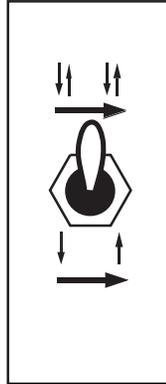
Placer le commutateur en position vers le BAS pour le fonctionnement en 2 Temps ou en position vers le HAUT pour l'opération de Verrouillage de la Gâchette.
