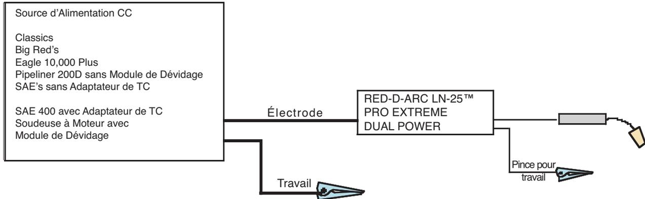
Si la source de puissance possède un interrupteur À Distance/Local, le placer sur la position « Local ».
