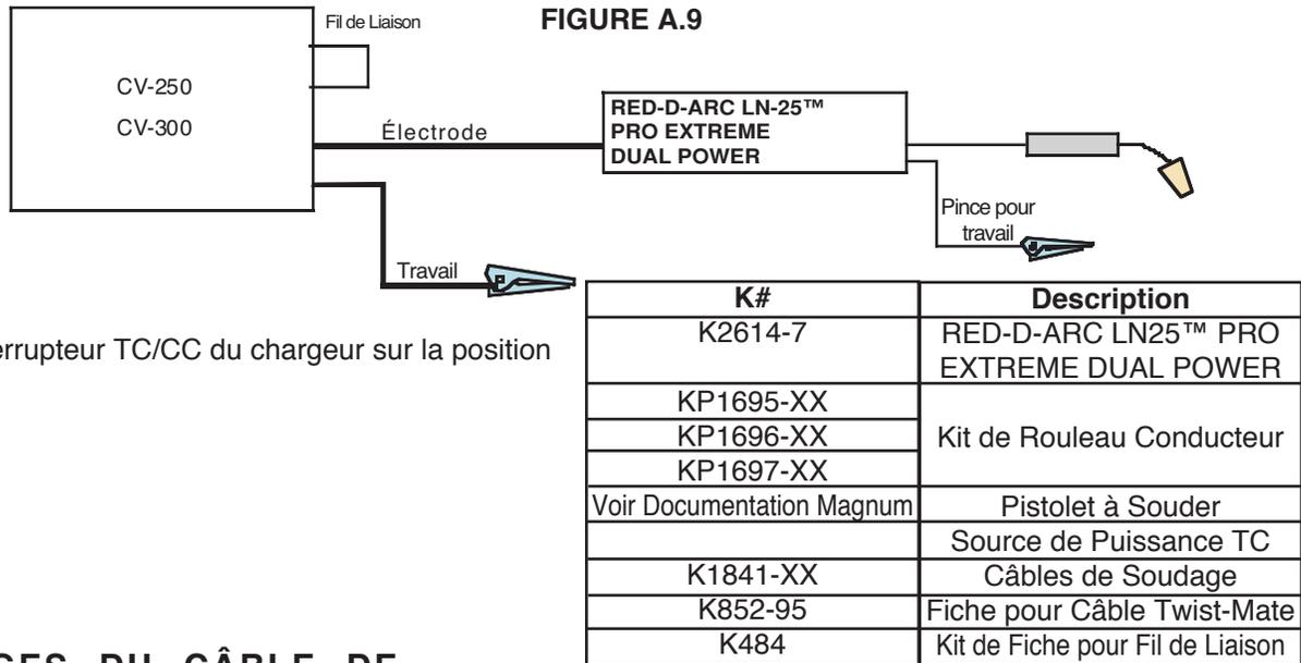
Placer l'interrupteur TC/CC du chargeur sur la position « TC ».
