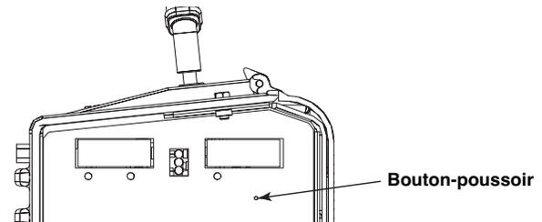
Pour accéder au menu de réglage, utiliser un trombone pour appuyer sur le petit bouton situé sur l'avant de la console.
