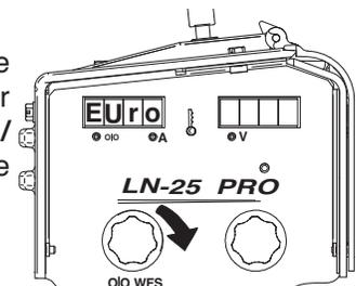
Appuyer sur le bouton de réglage pour accéder au menu de calibrage de la WFS.
