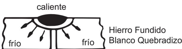
Esta es la razón por la que las soldaduras en hierro fundido se rompen. De hecho, una pieza del hierro fundido roto tiene toda la soldadura en ella y la otra no. (Vea la siguiente figura.)
