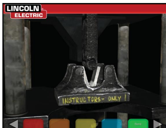
图 102 - 已完成的弯曲测试
