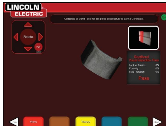
图 100 - 已完成的弯曲测试
