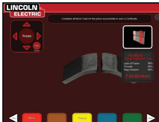
图 102 - 已完成的弯曲测试
