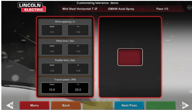
图 81 - 焊接工艺参数屏幕
