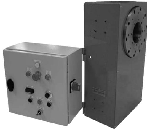
Il est possible de travailler avec l'armoire électrique à 3 mètres de la poupée.
