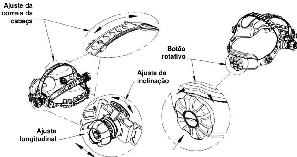
**AJUSTE AO TAMANHO DA CABEÇA:** o APERTO DO ARNÊS é regulado pressionando o botão rotativo e rodando-o para adaptar ao tamanho de cabeça pretendido. Este botão encontra-se na parte de trás da máscara. **REGULAGENS DO CAPACETE CROWN** são feitas através do ajuste para maior conforto e fazendo encaixar os fechos no furo para bloqueá-lo firmemente no lugar.
