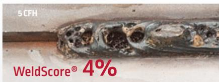
Soudure inacceptable – Un faible débit du gaz de protection entraîne des défaut par porosités.
