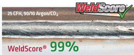
Soudure acceptable – Un débit et une protection gazeuse appropriés produisent une excellente soudure sans porosité.
