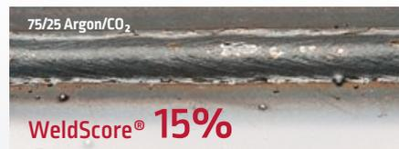
Soudure inacceptable – Un mélange de gaz incorrect entraîne des niveaux élevés de projections.
