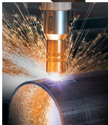
Système de coupe plasma avec coupe de tubes
