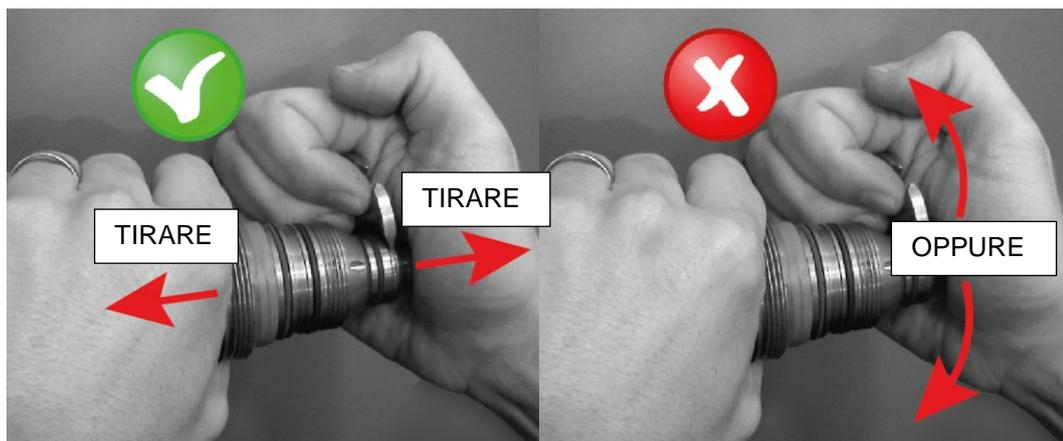
6. Utilizzare l'utensile per la rimozione del diffusore (P/N BK260105) per rimuovere l'anello dall'ugello.
