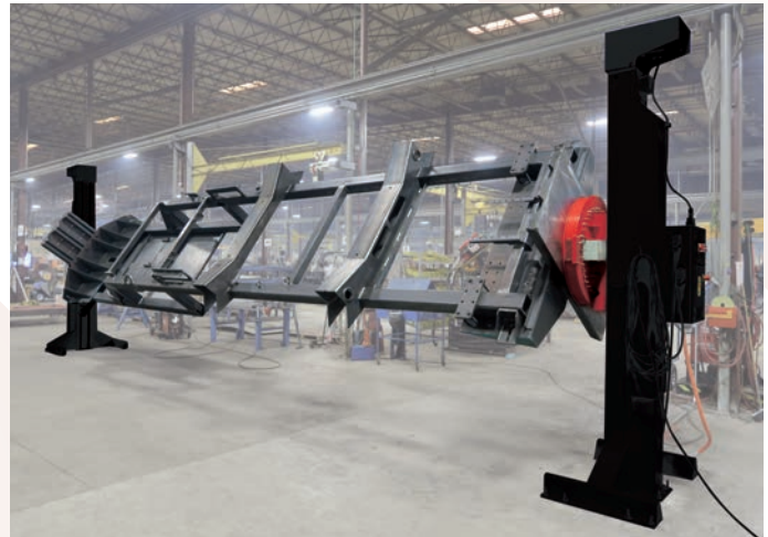
HEADMATIC – 2 Achsen 2000 bis 30 000 kg
