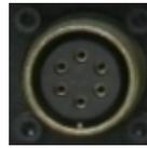
Consulte la sección de accesorios para ver los controles remotos disponibles. Si utiliza un control remoto, este se deberá conectar al conector ubicado en la parte delantera de la máquina. El equipo detectará automáticamente el control remoto y encenderá el LED REMOTO. En la sección siguiente encontrará más información acerca de este modo de funcionamiento.
