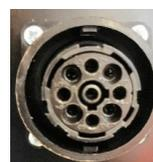
El **COOLARC 46** está alimentado por una máquina de soldar equipada con un conector de 9 patillas.
