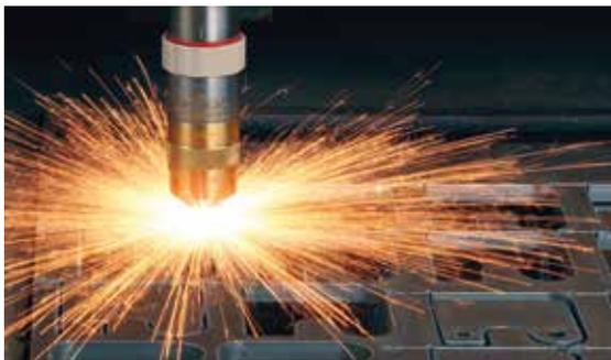
**Beim manuellen oder automatischen Schneiden** mit Gas oder Plasma entsteht Rauch über dem geschnittenen Material und **wird daher oberhalb der Arbeitsfläche abgesaugt.**
