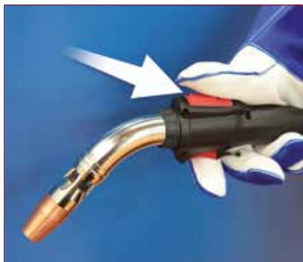
Die Anpassung des Absaugvolumens wird vom Bediener durch Drücken des Mikroschalters gesteuert.
