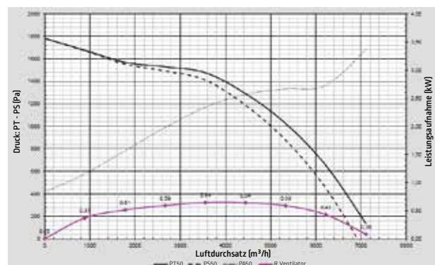
PT: Gesamtdruck (Pa) - PS: Statischer Druck (Pa) - PA: Leistungsaufnahme (kW)
