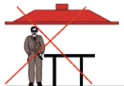
In diesem Fall würde sich das Gesicht des Bedieners zwischen Rauchemissionspunkt und Haube befinden.
