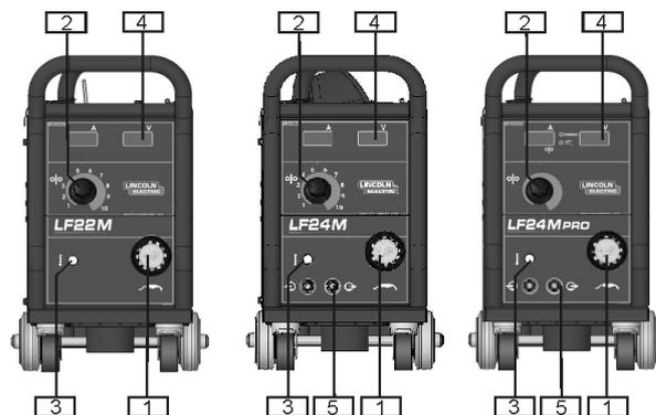
1. Encaixe EURO: Para conexão da tocha de soldadura.
