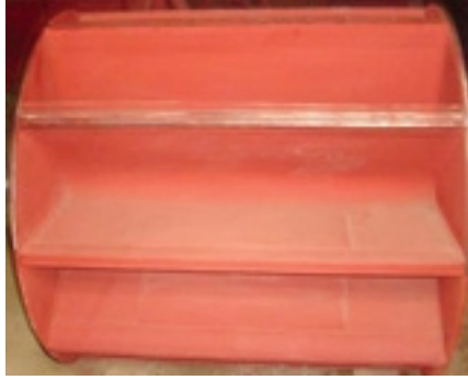
Weartech® ile Korunmuş Tambur — Montaj Aşaması —
