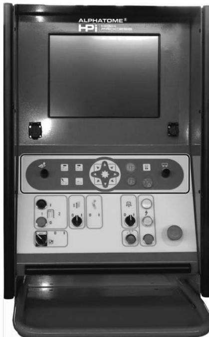
O **HPC** permite gerir automaticamente os parâmetros de corte em função da instalação e do material a cortar associados a programas peças.
