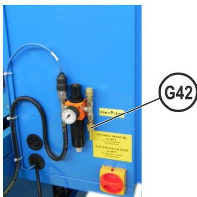
Raccorder le tuyau air comprimé sur le filtre situé sur le côté du coffret électrique en rep **G42**.
