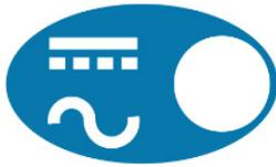
Este icono permite definir el tipo y polaridad de la corriente del proceso de soldadura empleado: CC+, electrodo revestido en CA, TIG en CC y en CA.
