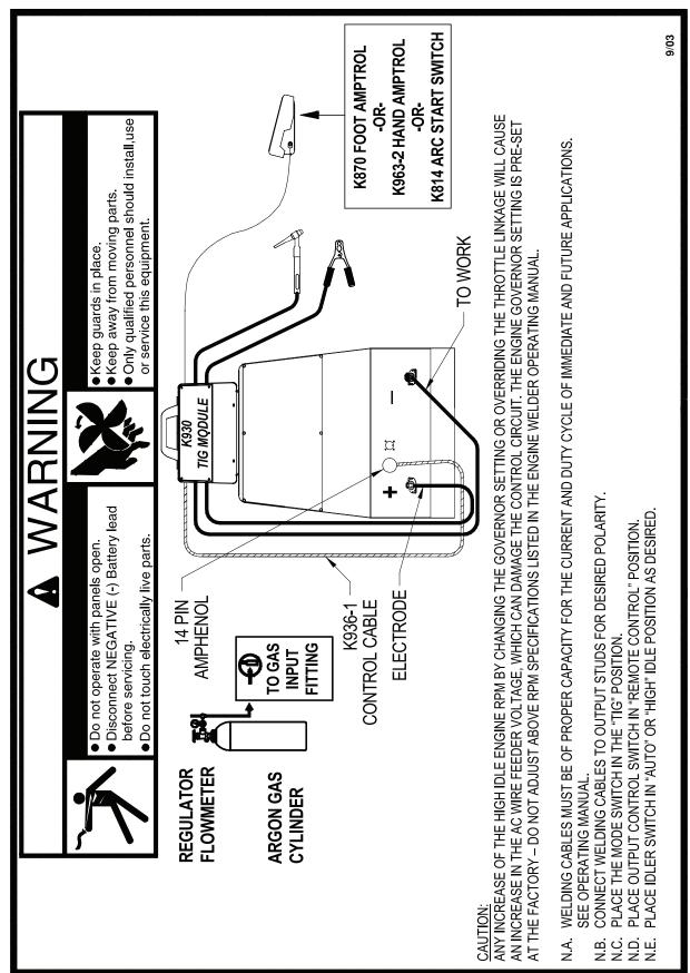
Ranger 305D (AU) Kubota Wiring Diagram - Code 11692, 12193
