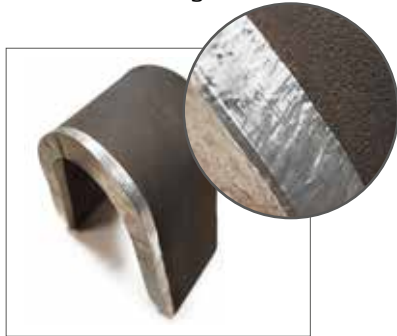
180° Seitenbiegeprobe einer Ni-625-Plattierung mit Hybrid-Technik
