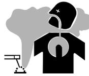
Les fumées et le laitier produits par les fils-électrodes du type Innershield recommandés pour ce type de machine de soudage peuvent être toxiques.
