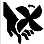
1.f. Ne pas mettre les mains près du ventilateur du moteur. Ne pas appuyer sur la tige de commande des gaz pendant que le moteur tourne.
