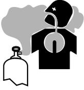
**UNE ACCUMULATION DE GAZ DE PROTECTION peut être néfaste pour la santé ou être mortelle.**
