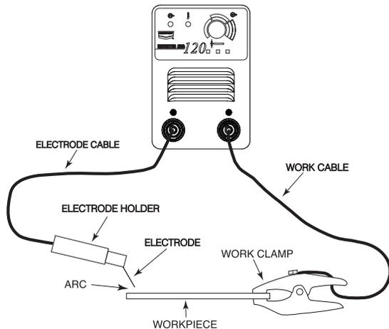
La corriente fluye a través del cable del electrodo y portaelectrodo al electrodo y a través del arco. En el lado del trabajo del arco, la corriente fluye a través del metal base al cable de trabajo y de regreso a la máquina de soldadura. El circuito debe estar completo para que la corriente fluya.
