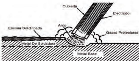
Esta figura ilustra muy bien lo que se ve en realidad durante la soldadura. La "corriente del arco" se ve en medio de la imagen. Esto es el arco eléctrico creado por la corriente eléctrica que fluye a través del espacio entre el extremo del electrodo y el trabajo.
