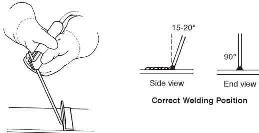
5. A medida que el electrodo se quema, éste debe ser alimentado al trabajo para mantener la longitud de arco correcta. La forma más fácil de decir si el arco tiene la longitud correcta es escuchando cómo suena. Un buen arco corto tiene un sonido de “chisporroteo” distintivo, muy parecido al de unos huevos friéndose en el sartén. El arco largo incorrecto tiene un sonido hueco, de soplido o silbido.
