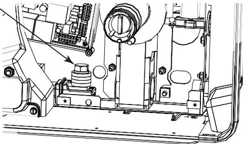
4. Enrute el cable del electrodo a través del alimentador como se muestra.
