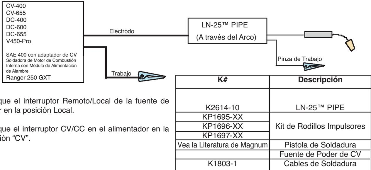
Coloque el interruptor Remoto/Local de la fuente de poder en la posición Local.
