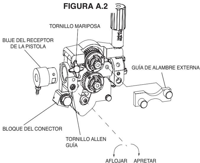
8. Conecte la manguera del gas protector al nuevo buje de la pistola, si se requiere.
