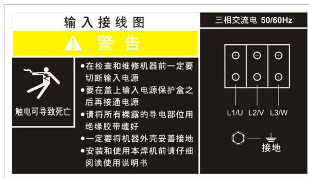
图 A.1 – 输入电源接线图
