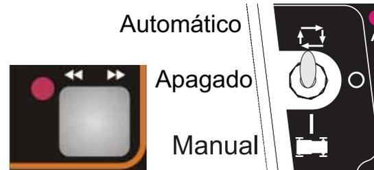
3. Oprima el botón de avance y manténgalo así, o coloque el interruptor de palanca en la posición de recorrido MANUAL.
