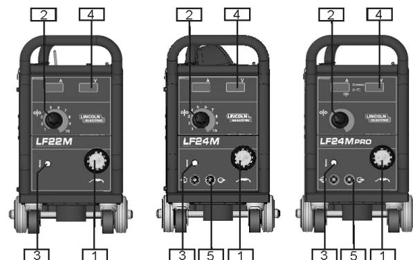
1. EURO-Anschluss: Zum Anschluss des Brenners.
