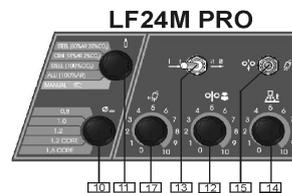
10. Einstellknopf Drahtdurchmesser: Ermöglicht die Einstellung des Drahtdurchmessers, für den Schweißprozess. Dieses Merkmal ist nur im synergetischen Betrieb verfügbar.
