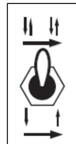
Stellen Sie den Kippschalter für den 2-Stufen-Betrieb in die Stellung UNTEN oder für den Betrieb mit Auslösersperre in die Stellung OBEN.
