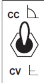
In der Stellung Konstantspannung (CV) bleibt die Drahtvorschubgeschwindigkeit während des Schweißens konstant. Die Stromquelle regelt die gleichbleibende Lichtbogenspannung durch Anpassung des Lichtbogenstroms.
