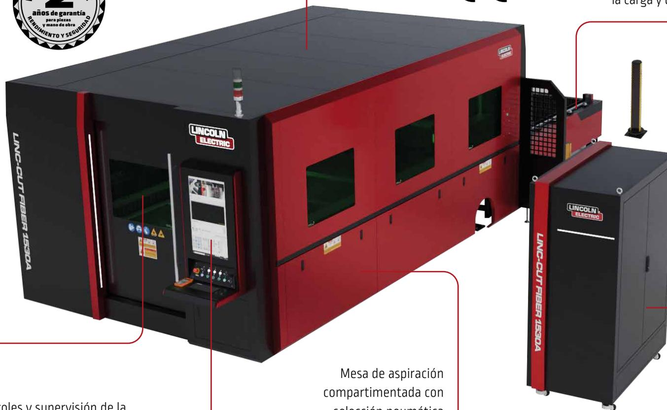
Mesa de aspiración compartimentada con selección neumática interconectada al filtro autolimpiante DIGIFILTER para una extracción de humos eficaz.
