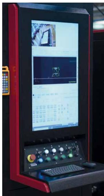
Está equipado con una gran pantalla de control que integra la visualización de dos cámaras de monitorización. Controla todas las operaciones de la máquina. Incluye software de trefilado y anidamiento automático y parámetro de base de datos para todos los espesores en materiales de acero al carbono, acero inoxidable y aluminio.
