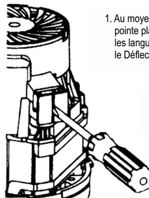
1. Au moyen d'un petit tournevis à pointe plate, écarter PRUDEMMENT les languettes en plastique et retirer le Déflecteur du Ventilateur.
